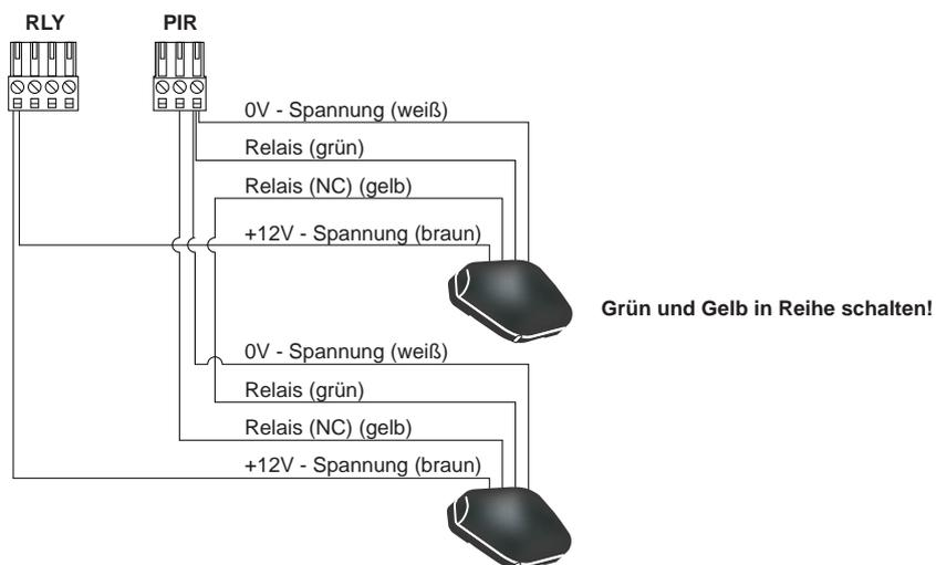
**HINWEIS!** Bei der Verwendung von mehr als 2 Sicherheitssensoren wird eine separate Stromversorgung (12V) benötigt!
