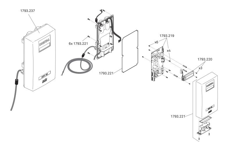
1793.219 Platine mit Steuerelektronik
