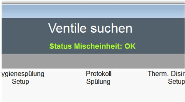
Der **“Ventilstatus”** wird unter dem Titel des Programmierfensters in farbiger Schrift angezeigt. Fehlermeldungen werden in roter Schrift angezeigt.
