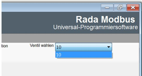
Sie können von allen Programmierfenstern aus zwischen den Sensorboxen und den daran angeschlossenen Mischventilen hin und her wechseln, indem Sie auf das Drop-Down-Feld am oberen rechten Rand klicken und das gewünschte Ventil auswählen.
