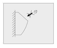
Feste dezinfektionsmitteln(Granulen, Würfeln, Eiern, ...) in Urinalkeramik **einlegen ist nicht möglich**, das führt zur zyklischen Spülungen bis der Auflösung.
