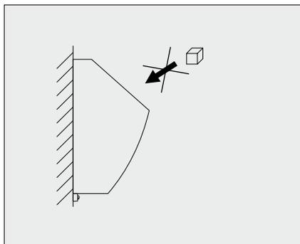
Feste Desinfektionsmittel (Granulen, Würfeln, Eiern, ...) in Urinalkeramik **einlegen ist nicht möglich**, das führt zur zyklischen Spülungen bis der Auflösung.
