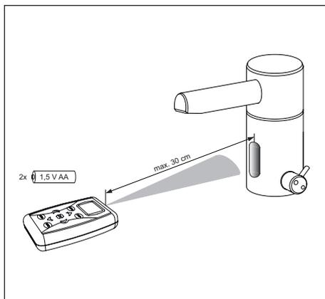
Für die Programmierung der Rada Tec 200 Armatur wird der Rada Tec Handprogrammierer benötigt. Dieser ist als Zubehör unter der Artikelnummer 02 9300 12A erhältlich.
