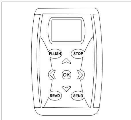
Um die eingestellten Werte in der Armatur zu speichern, richten Sie den Handprogrammierer auf den Infrarotsensor und drücken Sie die Taste "SEND".
