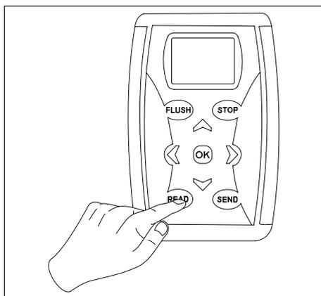
Vor dem Programmieren müssen die aktuellen Einstellungen aus der Armatur ausgelesen werden. Richten Sie dazu den Handprogrammierer auf den Infrarotsensor und drücken Sie die Taste "READ". Die programmierten Einstellungen erscheinen auf dem LCD-Display.
