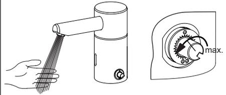
Überprüfen Sie die maximale Mischwassertemperatur. Wenn die Temperatur weiterhin zu hoch ist, wiederholen Sie bitte Schritt 2 & 3 bis die gewünschte Maximaltemperatur erreicht ist.
