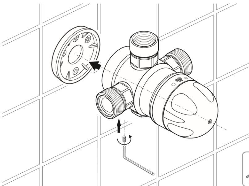
**6** Install the pipework / Installez les tuyaux / Installieren Sie die Rohrleitungen / Instale la tubería / Installare le tubazioni / Installeer de leidingen / Przymocować orurowanie / Namontujte potrubí / Boru tesisatını kurun / Monter rørene / Installera rörsystemet / Installer rørsystemet / 配管の取り付け
