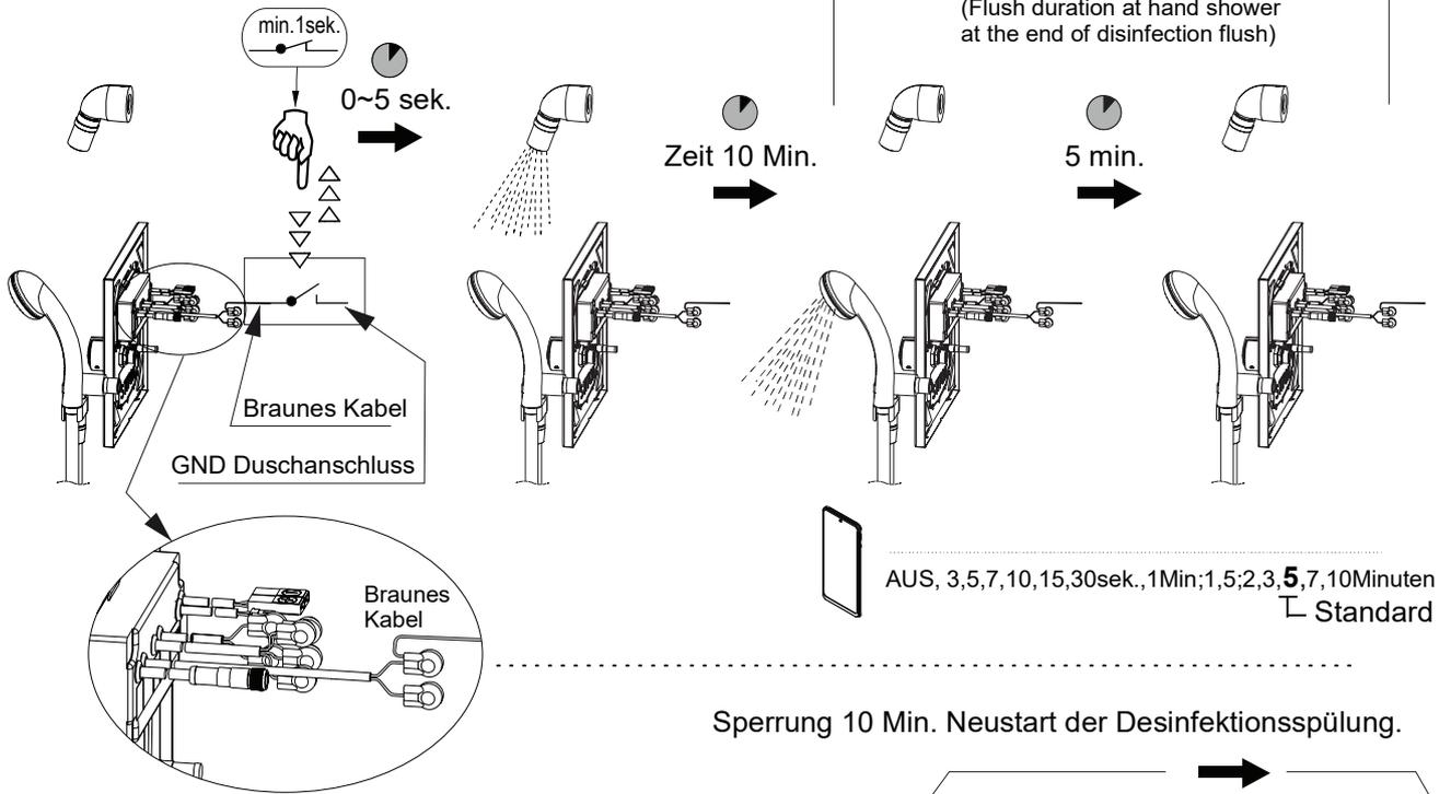
Sperrung 10 Min. Neustart der Desinfektionspflung.
