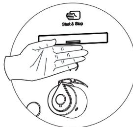
Durch Handannäherung mit kurzer Reichweite für die Dauer von mind. 6 Sekunden wird der Einstellmodus für die Hygienespülung aktiviert. Die LED blinkt rot.
