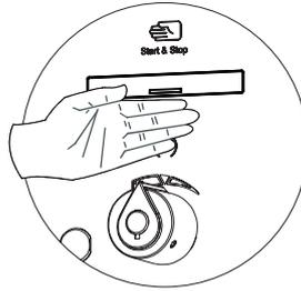
Durch Handannäherung mit kurzer Reichweite für die Dauer von mind. 6 Sekunden wird der Einstellmodus für die Hygienespülung aktiviert. Die LED blinkt magenta.
