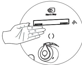
Bei der Variante mit Doppel-IR-Sensor den Sensor für die Kopfbrause verwenden!
