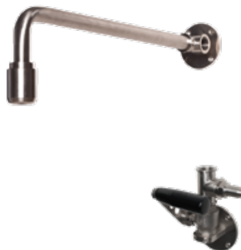
Nooddouche, rvs, met hendelbediening met automatische leegloop, zonder stijgpip, aansluitingen 3/4" bi. dr. (bestaande uit de componenten: 2.1931.131, 2.1931.202 en 2.1930.810, zie pagina 22 en 23 voor de componenten)
