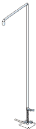
Model 2.1931.387 (Art.nr. 830195) Vrijstaande nooddouche met voetbediening en automatische leegloop. (pagina 17)
