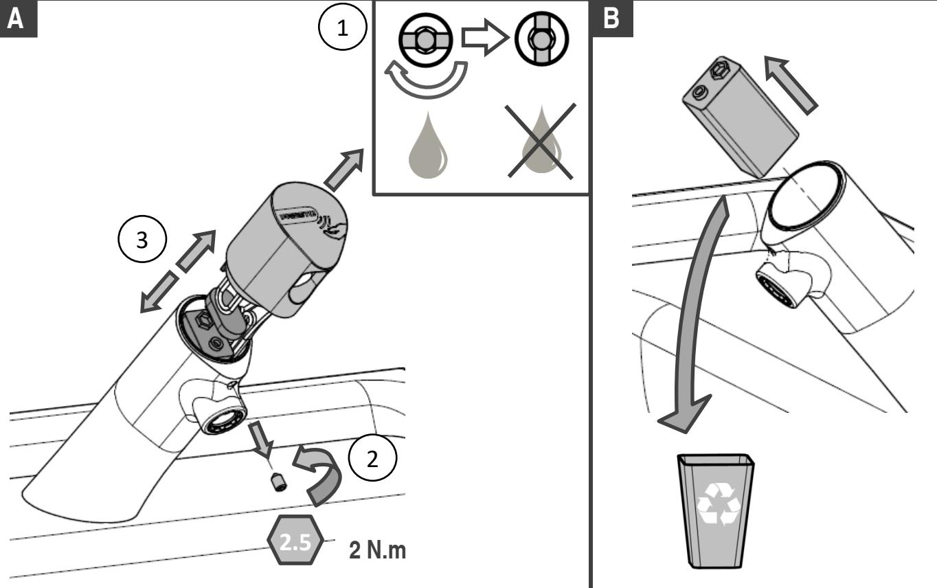
**7-2 Remplacement/ Nettoyage du filtre et électrovanne / Replacing/ Cleaning the filter and the solenoid valve / Filterreinigung /Auswechseln des Magnetventils / Sustitución /Limpieza del filtro y de la electroválvula / Sostituzione /Pulire il filtro e l'elettrovalvola / Vervanging/Reiniging van filter en magneetventiel**
