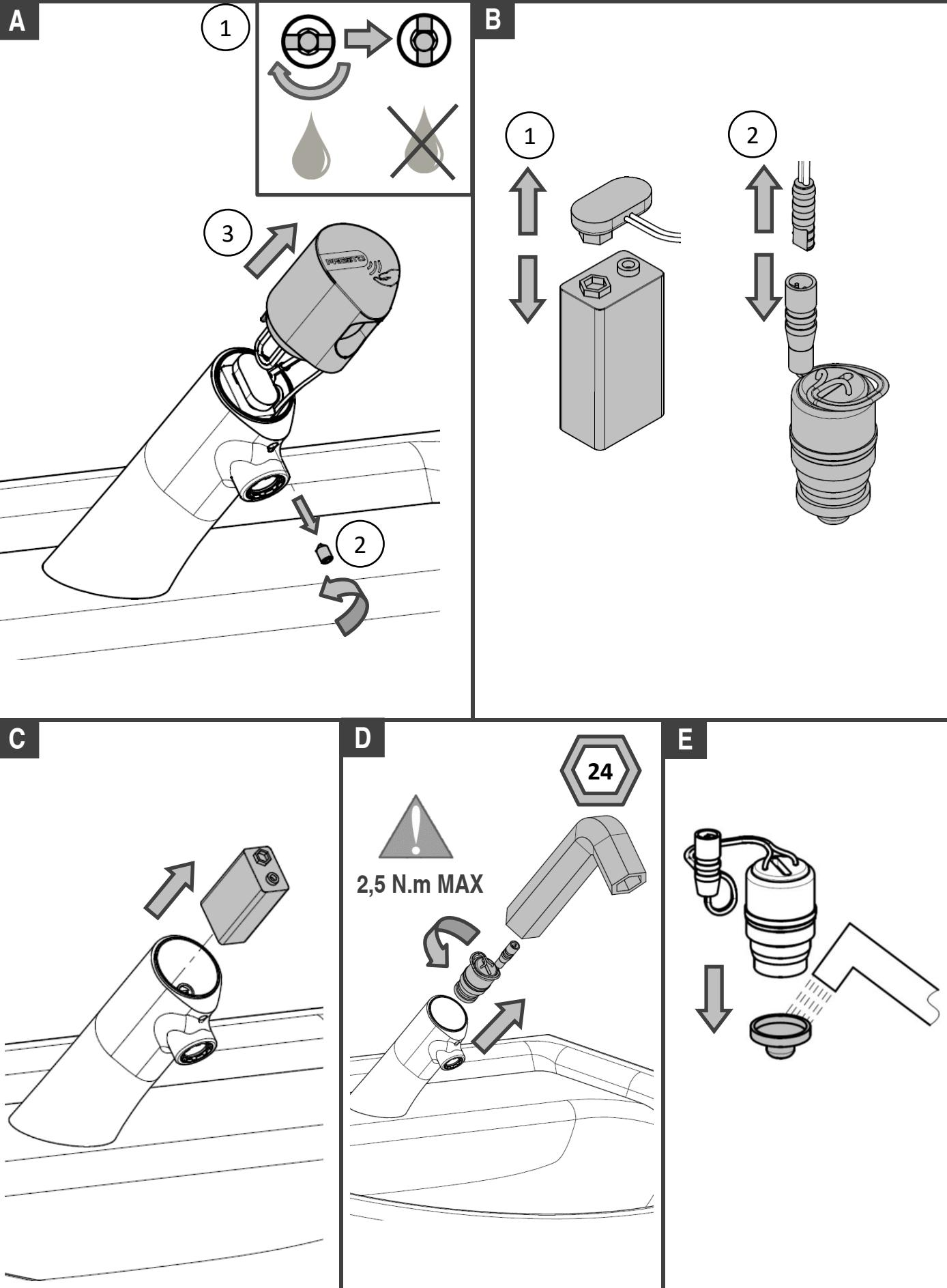
**7-3 Remplacement cellule / Replacing the cell / Auswechseln des Sensors / Sustitución de la célula / Sostituzione della fotocellula / Vervanging van de cel**
