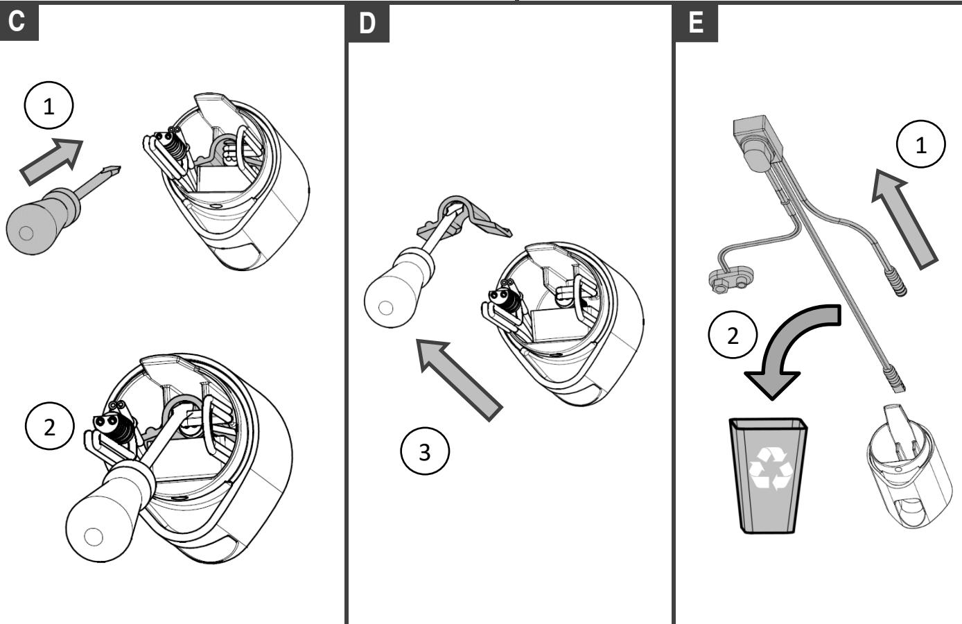
**7-4 Maintenance de l'aérateur / Maintenance of the flow aerator / Wartung Perlator / Mantenimiento del aireador / Manutenzione dell'areatore / Onderhoud beluchter**
