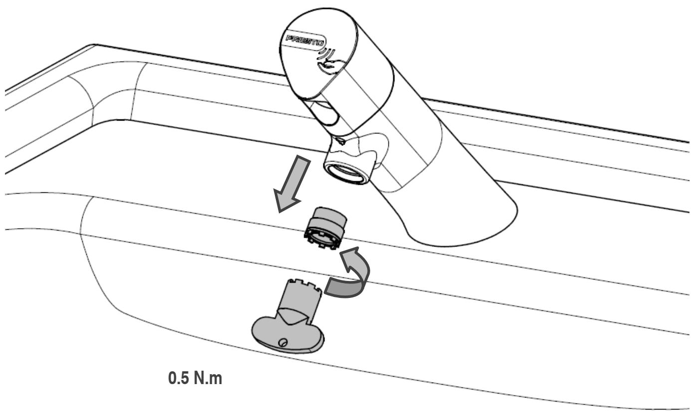
**7-5 Maintenance de l'axe de mitigeage / Maintenance of the mixer shaft / Wartung der Achse der Mischer / Mantenimiento del eje de mezcla / Manutenzione della leva di miscelazione / Onderhoud meng-as**
